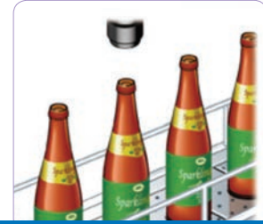
Doldurulmaya hazır şişelerde çatlak, çapak ve yabancı madde kontrolü
